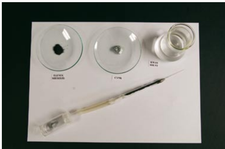
Zdjęcie 2. Reagenty oraz zmontowany aparat wraz cynkiem i CuO
