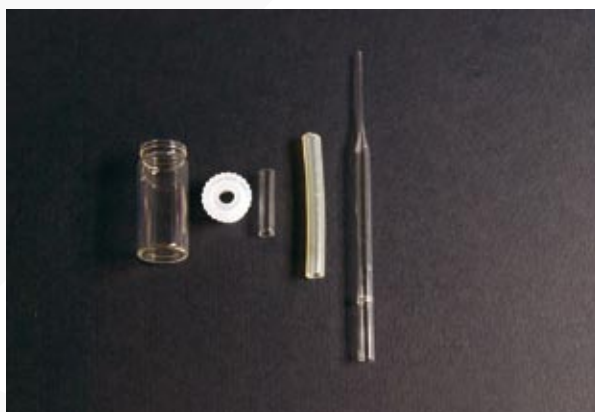
Zdjęcie 1. Elementy składowe aparatu do redukcji tlenku miedzi(II) wodorem
