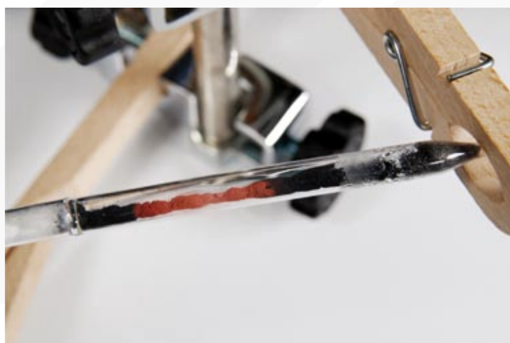
Zdjęcie 5. Widok pipety Pasteura z tlenkiem miedzi(II) i metaliczną miedzią powstałą w procesie redukcji oraz kropkami utworzonej wody
