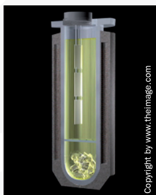
Rys. 2. Schemat autoklawu do hodowli kryształu górskiego
