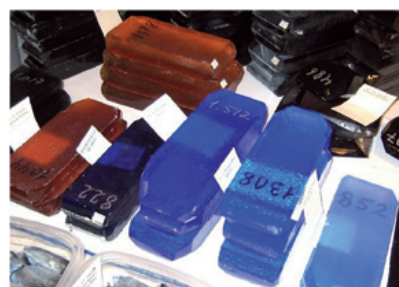
Fot. 8. Kryształy kwarcu hodowanego metodą hydrotermalną
